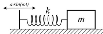
В этом случае у нас на тело будет действовать дополнительная сила  $F(t) = F_0 \cos(\omega t)$ , где  $F_0$  определяется максимальным натяжением пружины, при этом мы немного упростим задачу, приняв начальную фазу колебаний стенки равной нулю. Такая сила называется *вынуждающей*.
